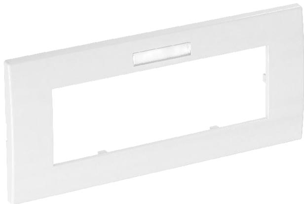
Frontrastender Abdeckrahmen für Modul 45 Einbaugeräte, 3fach, mit Beschriftungsfeld für waagerechte Geräteinstallation, zum Rasten in Geräteeinbaudose 71GD9-2 oder in Montageträger 71MT3 45-2.
