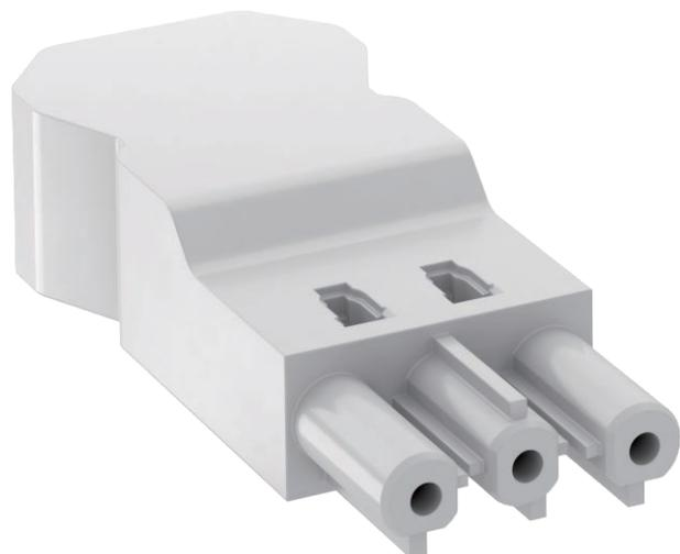
Buchsenteil 3-polig, Typ GST18i mit Schraubanschluss für Leitungen 1,5 - 4,0 mm<sup>2</sup> und für Leitungsdurchmesser von 10,5 - 14,5 mm (H05VV, NYM), unmontiert mit Zugentlastung, vor Ort konfektionierbar, 250 V, 16 A.
