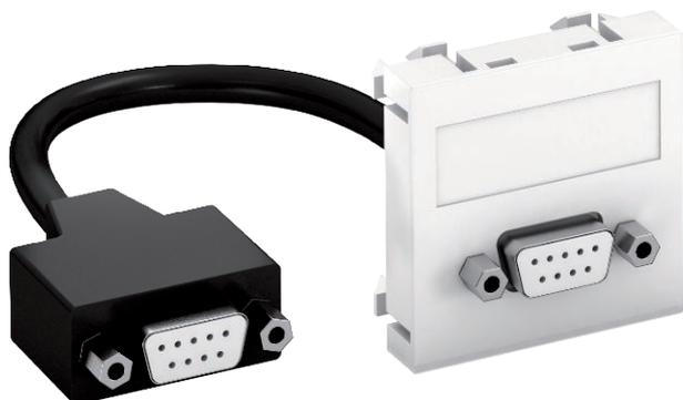
Multimediaträger mit einer D-Sub9-Anschlussbuchse, Kabelauslass gerade, mit Beschriftungsfeld, kurzes D-Sub9-Anschlusskabel (RS232) in Ausführung Buchse-Buchse. Träger mit Rastbefestigung, geeignet für den waagerechten und senkrechten Einbau in die Systemumgebung.
