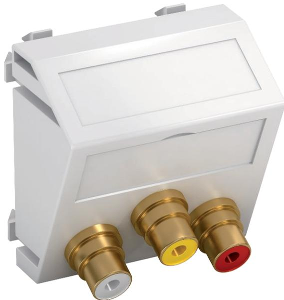
Multimediaträger mit drei Cinch-Anschlussbuchsen für Audio-Video, Kabelauslass schräg, mit Beschriftungsfeld, drei Cinch-Kupplungen (RCA) in Ausführung Buchse-Buchse, Farbkodierung gelb/rot/weiß. Trägerplatte mit Rastbefestigung, geeignet für den waagerechten und senkrechten Einbau in die Systemumgebung.
