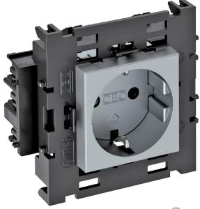
Schutzkontakt-Steckdose mit seitlichem Anschluss 1-fach 0°, mit erhöhtem Berührungsschutz, mit Steckklemmen, 2-polig, 16 A, 250 V $^\sim$ , mit Verbindungsklemmen nach IEC 60884-1, geeignet für den Einbau in Geräteeinbau-Kanalsysteme Rapid 80.
