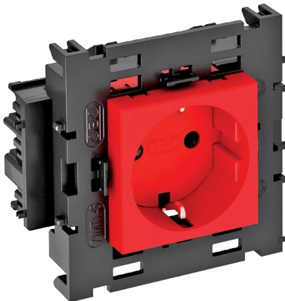
Schutzkontakt-Steckdose mit seitlichem Anschluss 1-fach 0°, mit erhöhtem Berührungsschutz, mit Steckklemmen, 2-polig, 16 A, 250 V~, mit Verbindungsklemmen nach IEC 60884-1, geeignet für den Einbau in Geräteeinbau-Kanalsysteme Rapid 80.
