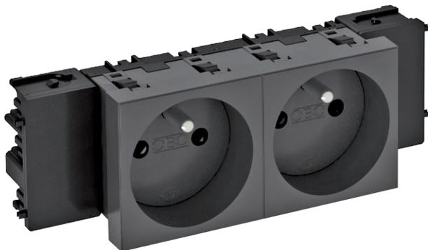
Erdungsstift-Steckdose mit seitlichem Anschluss 2fach 0°, mit erhöhtem Berührungsschutz, mit Steckklemmen, 2-polig, 16 A, 250 V~, mit Verbindungsklemmen nach IEC 60884-1, geeignet für den Einbau in Geräteeinbau-Kanalsysteme Rapid 45.
