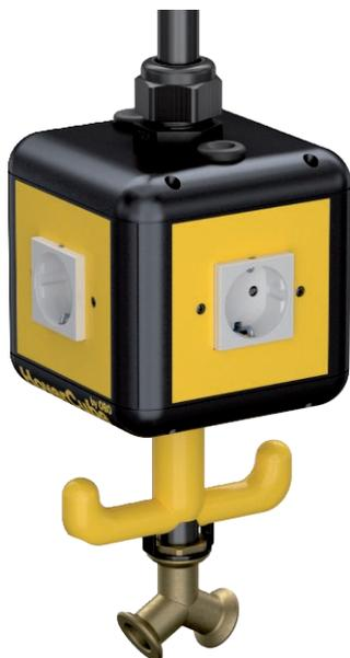
Gehäuse bestückt und vorverdrahtet, mit 1 m Rohr 1/2" und Anschluss für Druckluftschlauch 13 x 3,5 mm und 2-Wege-Verteiler 1/2", mit Aufhängeöse, Griffhaken und 4 Abdeckplatten.
