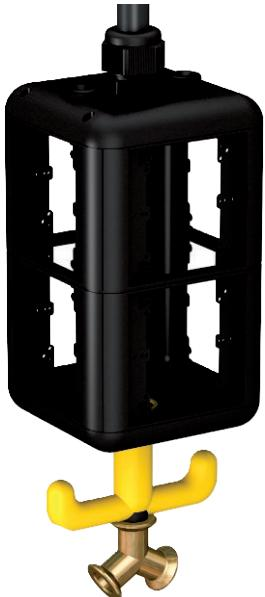
Leergehäuse mit 1 m Rohr 1/2" und Anschluss für Druckluftschauch 13 x 3,5 mm und 2-Wege-Verteiler 1/2". Mit Aufhängeöse und Griffhaken, zum Einbau von elektrischen Betriebsmitteln, mit beigelegter Trennwand. Ohne Abdeckplatten.
