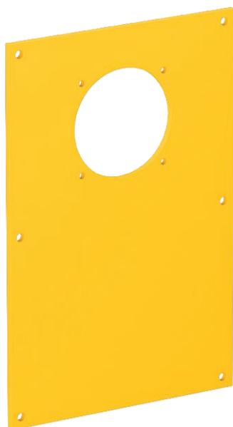
Abdeckplatte mit einer  $\varnothing$  45-mm-Öffnung zum Einbau einer Anbausteckdose (Typ ASD...) mit 38-mm-Befestigungsspur, inklusiv 4 Schrauben zur Gerätebefestigung.
