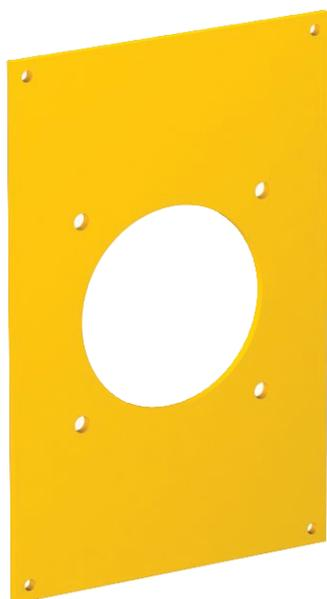
Abdeckplatte mit einer  $\varnothing$  70-mm-Öffnung zum Einbau von 1 x CEE-Steckdose 16/32 A mit 60-mm-Befestigungsspur, inklusiv 4 Schrauben zur Gerätebefestigung.
