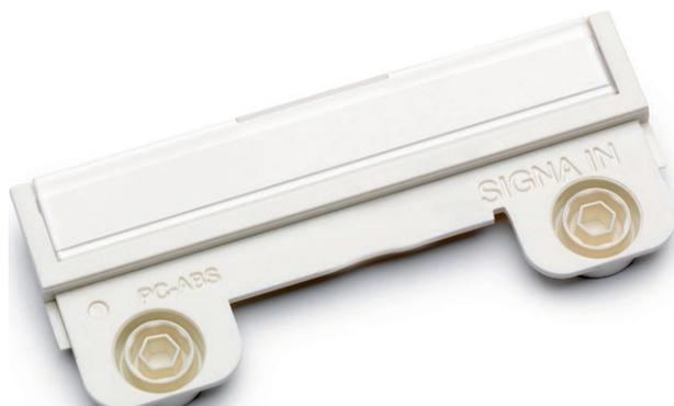
SIGNA IN Beschriftungsfeld vertikal, wird seitlich in den Blendrahmen der Kanalsteckdosen SIGNA IN eingerastet.
