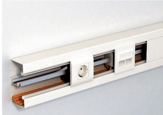
Durch den Einbau einer Geräteinbaudose ist der nutzbare Querschnitt, der zur Leitungsführung genutzt werden kann, eingeschränkt. Der Wert „netto“ in den Tabellen bezeichnet diesen nutzbaren Kanalquerschnitt.
