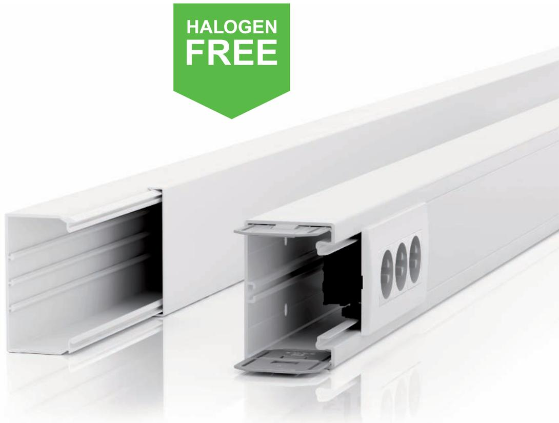
Halogenfreie Leitungsführungs-Systeme von OBO dienen dem Schutz von Menschen, Umwelt und Sachwerten. Alle Produkte bestehen aus hochwertigem PC/ABS (Polycarbonat/Acrylnitril-Butadien-Styrol). Dieses Material gehört zu den selbstverlöschenden Kunststoffen.
