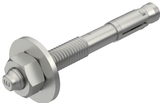
Bolzenanker BZ zur Verankerung mittelschwerer bis schwerer Lasten im Innen- und Außenbereich, sowohl im gerissenen als auch ungerissenen Beton. Er vereint hohe zulässige Lasten mit geringen Rand- und Achsenabständen.
