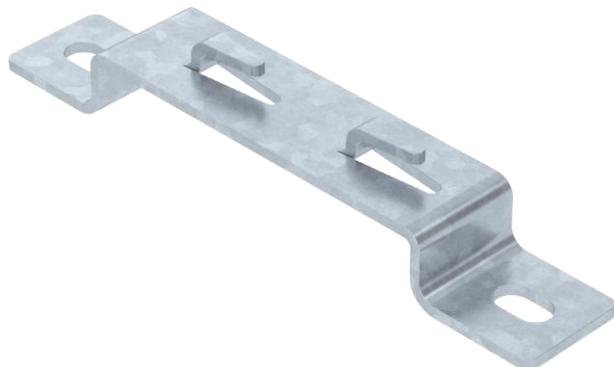
Distanzbügel zum Aufständern von Gitterrinnen auf dem Boden oder an der Wand. Auf dem Distanzbügel können die Gitterrinnentypen GRM mit den Seitenhöhen 35, 55 und 105 mm montiert werden.
