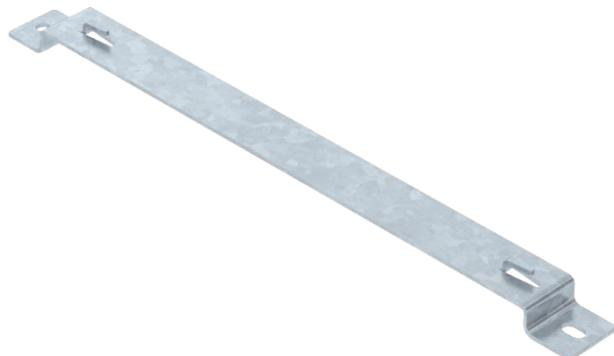
Distanzbügel zum Aufständern von Gitterrinnen auf dem Boden oder an der Wand. Auf dem Distanzbügel können die Gitterrinnentypen GRM mit den Seitenhöhen 35, 55 und 105 mm montiert werden.
