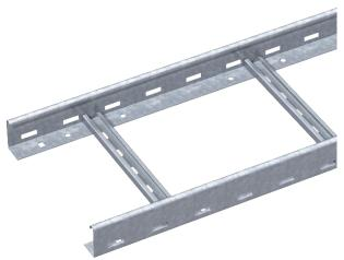
Kabelleiter mit gelochtem Seitenholm in der Seitenhöhe 60 mm mit eingenieteten, nach oben offenen C-Profil-Sprossen (Ausführung NS).
