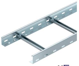
Kabelleiter mit gelochtem Seitenholm in der Seitenhöhe 60 mm mit eingenieteten, nach oben offenen C-Profil-Sprossen (Ausführung VS).
