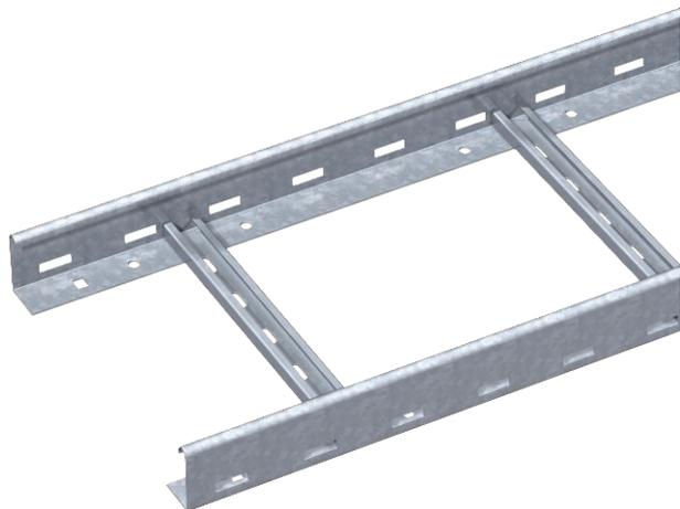
Kabelleiter mit gelochtem Seitenholm in der Seitenhöhe 60 mm mit eingieteteten, nach oben offenen C-Profil-Sprossen (Ausführung VS).
