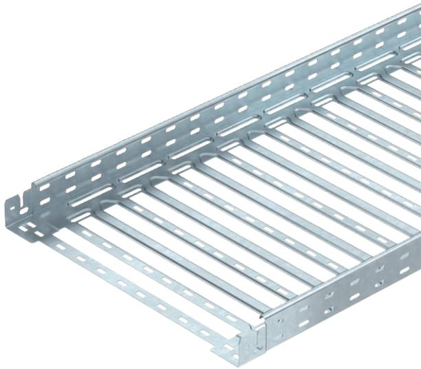
Kabelrinne mit integriertem Schnellbefestigungssystem. Die Nutzlänge der Kabelrinne beträgt 3.000 mm.
