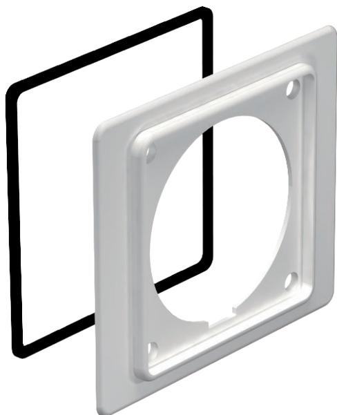
Zwischenflansch zur Montage von CEE Steckdosen 16A. Der Zwischenflansch wird bei der Montage von der Gerätedose CEE hinter das Kanaloberteil für Geräteinbaudosen montiert. Passend für 400 V CEE 16A 5-pol. 6h, Art.-Nr. 6109874.
