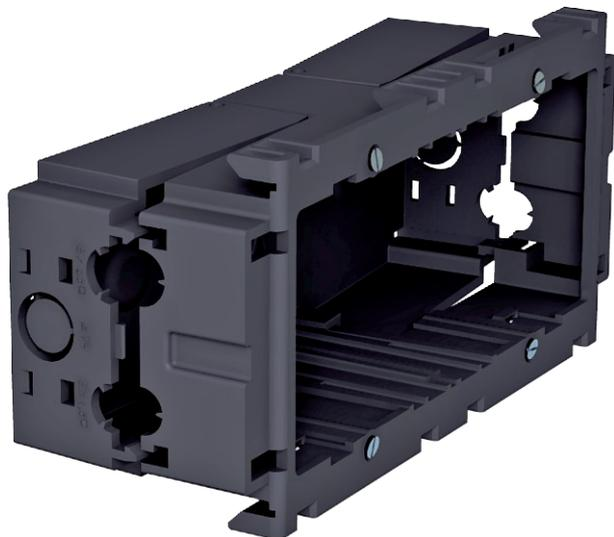
Frontrastende Geräteeinbaudose für Standard-Schalterprogramme zum Einbau von 2 Einzel-Installationsgeräten oder einer Mehrfach-Schutzkontakt-Steckdose. Mit abklappbarem und bei Bedarf auch entfernbarem Unterteil zum zeitsparenden Leitungsanschluss sowie mit Zuführungsöffnungen für Leitungsdurchmesser bis 14 mm. Halogenfreie Ausführung.
