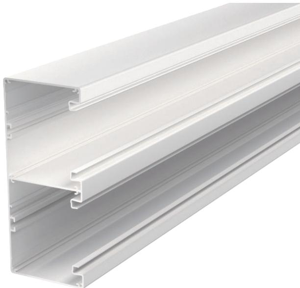
Geräteeinbaukanal ohne Bodenlochung zur direkten Wandmontage oder an Konsolen geeignet. Überlängen bis 6000 mm von Kanalunterteilen und -oberteilen sowie andere RAL-Farben können auf Anfrage realisiert werden. Die Sichtflächen der Geräteeinbaukanäle sind foliert.
