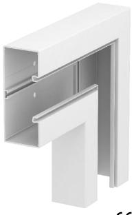
Flachwinkel aus halogenfreiem PC/ABS zur Richtungsänderung der GKH Geräteeinbaukanäle. Oberteil muss separat bestellt werden.
