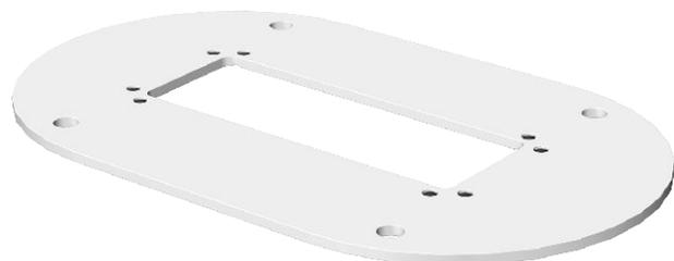
Bodenplatte mit 30 mm sichtbarem Rand und 4 Befestigungslöchern  $\varnothing$  8,5 mm. Die Bodenplatte eignet sich zur Montage von Installationssäulen vom Typ ISST70140, ISSOG70140 und ISST70140B.
