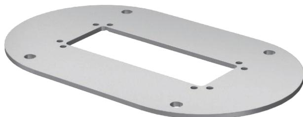
Bodenplatte mit 30 mm sichtbarem Rand und 4 Befestigungslöchern Ø 8,5 mm. Die Bodenplatte eignet sich zur Montage von Installationssäulen vom Typ ISST70140, ISSOG70140 und ISST70140B.
