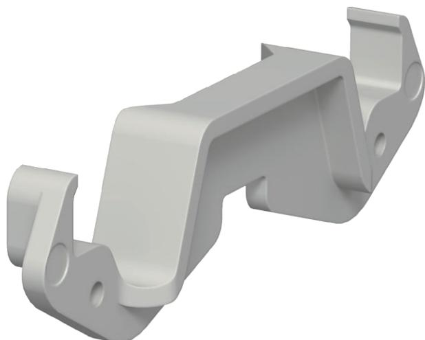
Kanalklammer zum sicheren Halt der Kabel und zur Fixierung der Trennwand in den Geräteinbaukanalsystemen Rapid 80 GK, GS und GA sowie in ISS Installationssäulen mit 76,5-mm-Systemöffnung.
