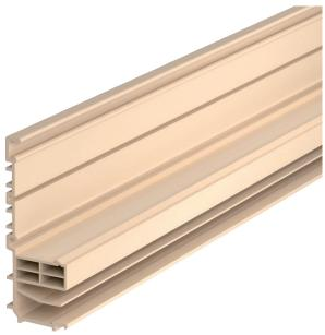
Unterteil des RAUDUO-Kanalsystems mit 2 thermisch getrennten Einzelkammern für die gemeinsame Verlegung von Elektro- und Heizungsleitungen. Mit Rastfunktion zur Aufnahme der Kanaloberteile. Die Farbe der Kanalunterteile kann fertigungsbedingt variieren.
