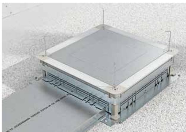
Die Unterflurdosen haben eine Mindestaufbauhöhe von 70 mm und einen Nivellierbereich von zusätzlichen 55 mm. Die Höheneinstellung erfolgt in zwei Schritten: Zuerst wird die Unterflurdose durch die integrierte Schnellnivellierfunktion grob auf die Estrichhöhe voreingestellt. Mit einem Schraubendreher erfolgt im zweiten Schritt die Feineinstellung auf die Oberkante des Estrichs.
