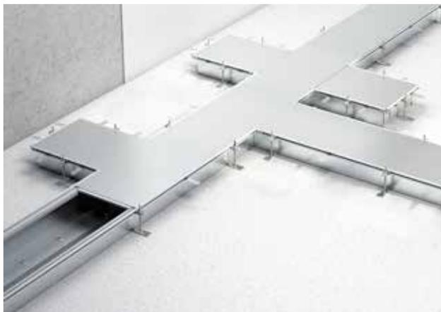
Die Kanaleinheiten werden montagefertig mit jeweils drei Abdeckungen geliefert. Die Kanaldeckel sind bei der Lieferung verschraubt und umreift. Im Lieferumfang sind sechs Nivelliereinheiten und Estrichanker enthalten, außerdem abhängig von der Kanalnennbreite noch drei Deckelstoßdichtungen oder sechs Deckelstoßunterstützungen.
