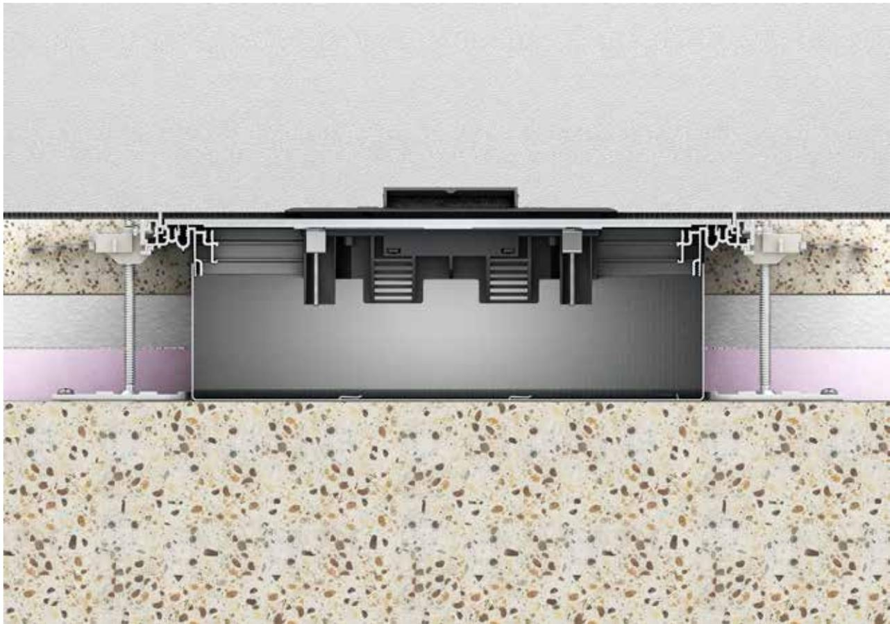
Reduzierung des Kanalquerschnitts durch Einbau eines Geräteinsatzes in mm<sup>2</sup>
