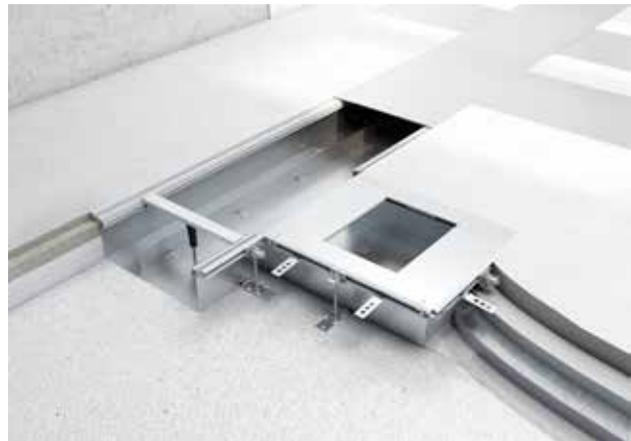
Die Estrichanker werden in das Aluminium-Seitenprofil des Kanals in gleichmäßigen Abständen eingehängt. Sie sorgen für den Verbund zwischen den Kanälen und der Estrichschicht. Um eine möglichst stabile Einbindung zu garantieren, darf keine Trennlage zwischen Kanal und Estrich eingebaut werden.
