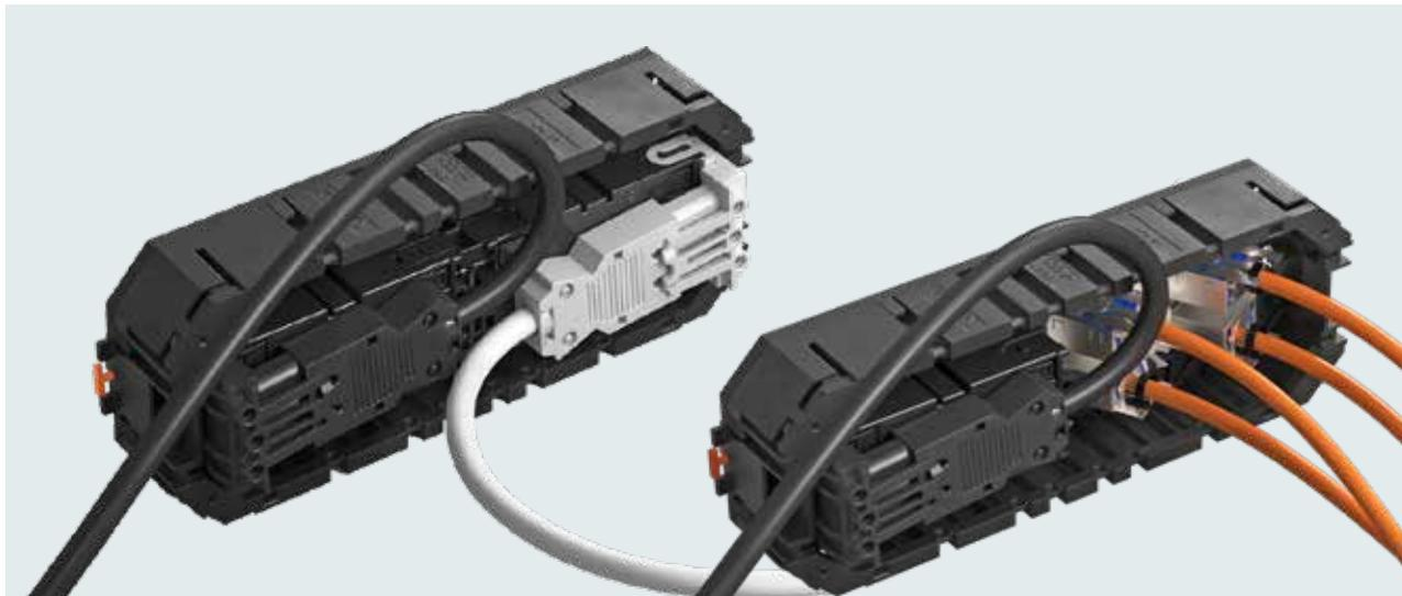
Die anschlussfertigen Universalträger connect UTC sind mit steckbaren Anschlussadaptern ausgestattet. Der Leitungsanschluss erfolgt direkt über Verbindungsleitungen an die Unterflur-Verteiler.
