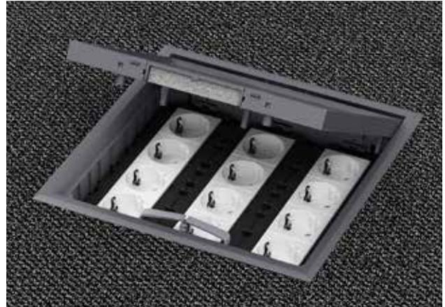
Der integrierte Schalkkörper der Im-Beton-Dose – ihre Außenwand – kann direkt in den Beton eingegossen werden. Ganz ohne Zwischenräume, die nachträglich verfüllt werden müssten, lässt sich der Beton so an die Dose heranarbeiten. Während die Außenwand fest im Beton liegt, bleibt der innere Schalkkörper flexibel nivellierbar. Seine Seitenwände sind für eine Standardhöhe von 80 Millimeter oberhalb der Dose ausgelegt.
