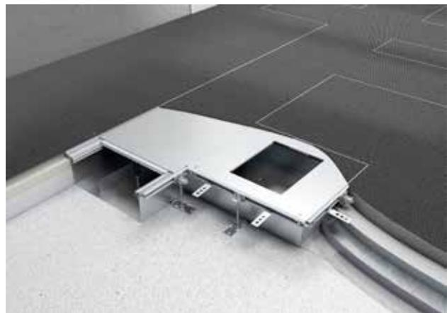
Ab 55 mm Bodenhöhe plus Bodenbelag ist der Einbau von Geräteinsätzen des Systems 55 möglich. Für eine Estrichhöhe ab 70 mm ist der standardmäßige Geräteinsatz GES verfügbar.
