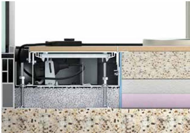
Das OKB-System verläuft direkt an der Wand oder an bodentiefen Fensterflächen. Das System wird vor den Estricharbeiten direkt auf dem Rohbeton verlegt. Alternativ kann es auch in eine vorbereitete Öffnung im Estrich eingebaut werden. Der 250 mm breite Kanal wird mittels einer Trennwand in zwei Züge aufgeteilt. Somit können Daten- und Stromleitungen getrennt voneinander verlegt werden.
