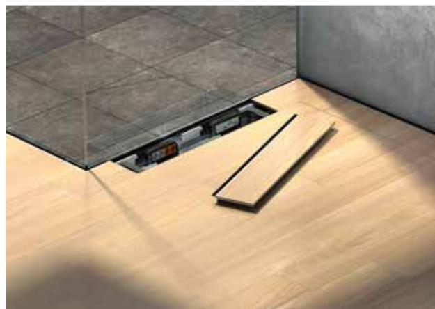
Nach der Estrichverlegung kann das Kanalsystem nach Nutzeranforderungen/Bedarf mit Steckdosen oder Datenmodulen bestückt werden. Über Schrauben im Seitenprofil kann die Bodenbelag-Anlegekante des Kanals in einem Nivellierbereich von 25 mm auf die Höhe der Oberkante des Fertigfußbodens eingestellt werden. Alle Deckel des OKB-Systems werden nach der Montage mit dem gewählten Fertigfußboden belegt.
