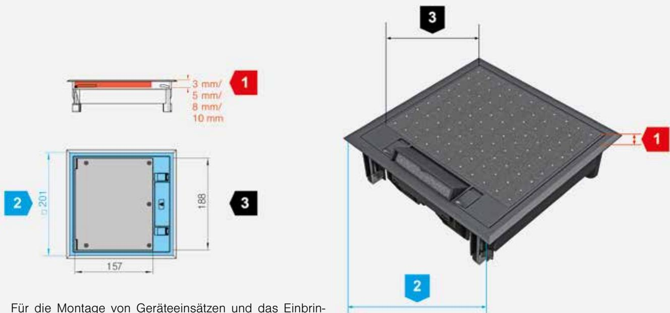
Für die Montage von Geräteeinsätzen und das Einbringen von Bodenbelägen in den Gerätedeckel sind verschiedene Einbau- und Bodenausschnittmaße zu berücksichtigen.
