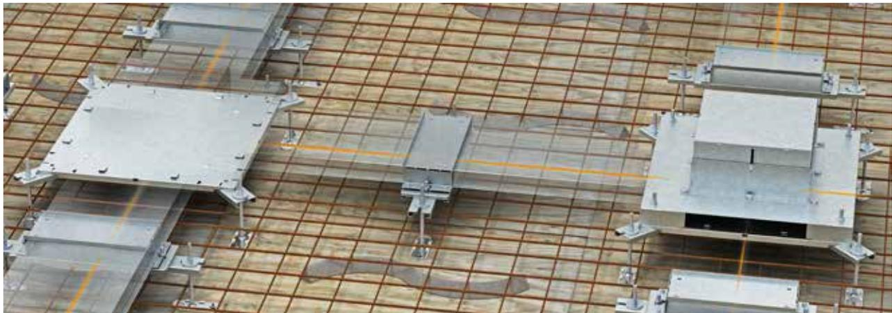
Das IBK-System liegt zwischen der unteren und oberen Bewehrung der Betonplatte. Das heißt, das Arbeiten zwischen den Strängen der Stahlmatten erschwert die Montage. Neue schwenkbare Nivelliereinheiten ermöglichen jetzt einen deutlich vereinfachten Einbau.
