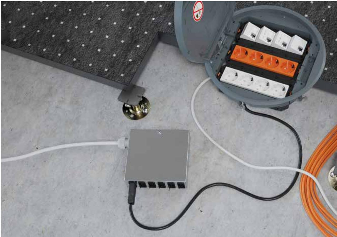
Energieverteiler kommen in Doppelböden mit abnehmbaren Bodenplatten zum Einsatz. Sie werden an zentralen Punkten unterhalb der Bodenflächen montiert und versorgen sternförmig die installierten Bodentanks.
