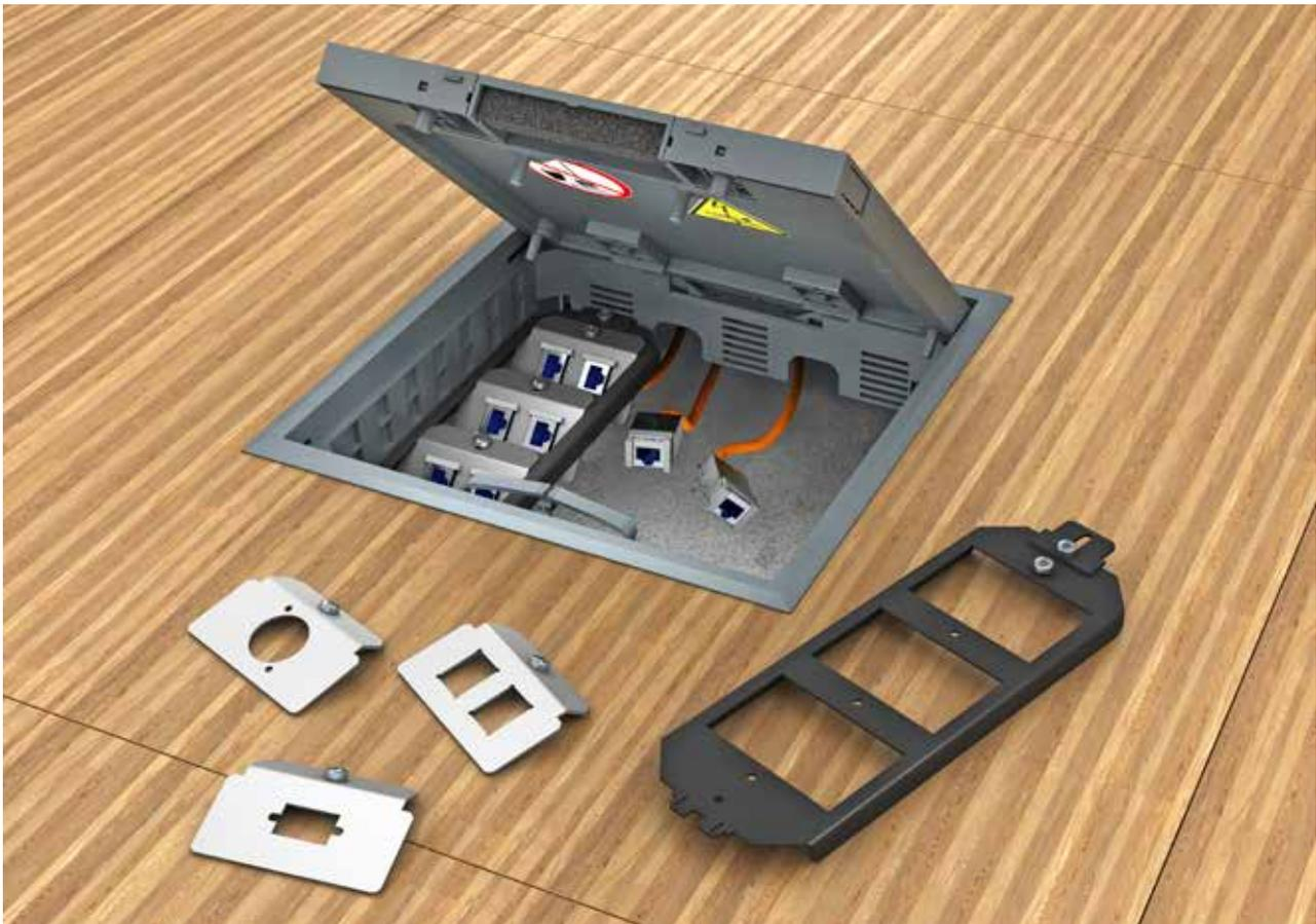
Der Montageträger MTU ist für die Aufnahme von Daten- und Multimediatechnik konzipiert. Datenanschlussmodule mit unterschiedlichen Baugrößen und Befestigungsarten sowie Multimedia-Komponenten lassen sich mit den passenden Trägerplatten vom Typ MTM problemlos im Montageträger installieren. Die notwendige Einbautiefe (Bodenaufbauhöhe) ist abhängig von den Einbaukomponenten und beträgt mindestens 80 mm.
