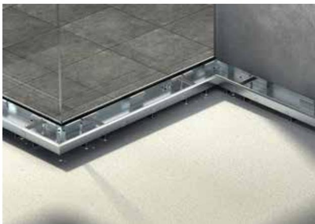
Zunächst werden die Nivelliereinheiten in den Kanal eingeschraubt. Anschließend werden die Kanalunterteile mithilfe der mitgelieferten Verbinder aneinander montiert. Mit Nivellierfüßen lässt sich das System genau auf die geplante Estrichhöhe einstellen. Mit entsprechenden Innen- und Außenecken kann der Kanal an die jeweilige Raumform angepasst werden.
