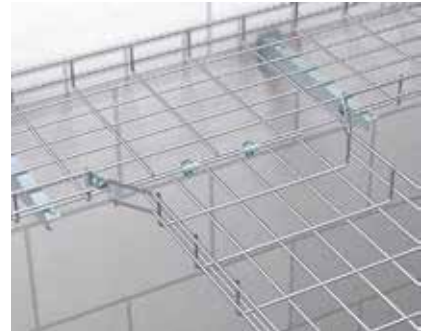
Herstellung eines Gitterrinnen-T-Abzweiges Nach Einschneiden der Seitenholme und Umbiegen der Laschen lassen sich mit dem Eckverbinder Typ GEV 36 und dem Stoßstellenverbinder Typ GSV 34 T-Abzweige im Selbstbau herstellen.
