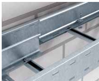
Geschraubte Trennstegbefestigung Trennstegmontage in Weitspannkabelleitern. Die Befestigung erfolgt mit Gleitmutter und Sechskantschrauben.
