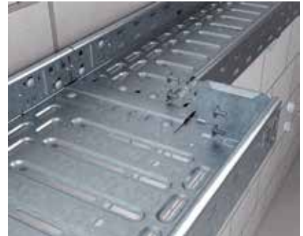
Breitenänderung und Endabschluss Darstellung einer Breitenänderung durch Einbau des Reduzierwinkels. Mit diesem Bauteil kann auch der Endabschluss von Kabelrinnen realisiert werden.
