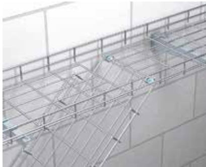
Herstellung eines vertikalen Abgangs Nach Einschnitt des Gitterrinnenbodens kann die vertikal abzweigende, zugeschnittene Gitterrinne mit dem Stoßstellenverbinder Typ GSV 34 fixiert werden.
