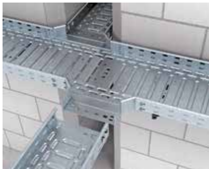
Montage Anbau-Abzweigstück Magic Montage von Formteilen durch einfaches Ineinanderstecken. Dabei wird die Kabelrinne mit der Federseite von oben in den Formteilanschluss gerastet.
