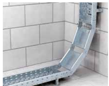
Montage Gelenkbogen vertikal steigend Gelenkbogen vertikal steigend zur Überbrückung von Höhenversätzen oder dem Wechsel von horizontal nach vertikal. Der Gelenkbogen wird direkt mit Gelenkverbindern an der Kabelrinne befestigt.
