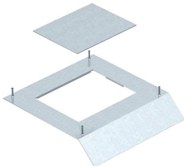
Geräteeinsatzdeckel für Kanalunterteil AIK/U für den Einbau eines Geräteeinsatzes der Nenngröße 6. Montageöffnung durch 2-mm-Alu-Blindplatte verschlossen. Der Kanaldeckel wird in den Al-S Seitenprofilen des Kanalunterteils festgeschraubt. Die Deckelschräge überragt das Kanalunterteil im 45°-Winkel.
