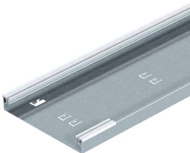
Aufflur-Installationskanal-Unterteil, 1-zülig, für Blind-/Montagedeckel mit einseitiger Abschrägung, mit aufsteckbaren Aluminium-Seitenprofilen zum Auflagern und Befestigen der Kanaldeckel, Bodenwanne mit Haltelaschen für max. 2 einsteckbare, selbstkontaktierende Trennsteg und Prägung für Schutzleiteranschlusswinkel. Kanalhöhe geeignet zum Aufbau von Teiltanks oder zum Einbau von Geräteinsätzen der Nenngröße 4, 6, 9.
