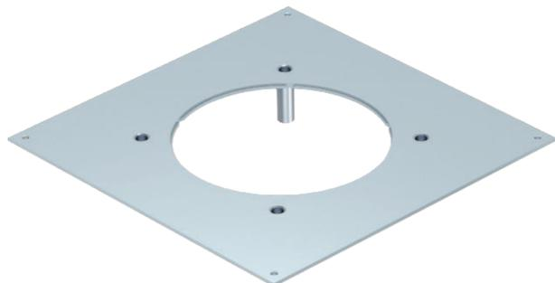
Der Schwerlast-Montagedeckel für die Unterflurdose vom Typ UZD350 eignet sich zum Einbau einer runden Schwerlastkassette der Nenngröße R4. Die Einbauöffnung ist um 3 mm vertieft und kann dadurch nachträglich mit einer Deckelblindplatte verschlossen werden.
