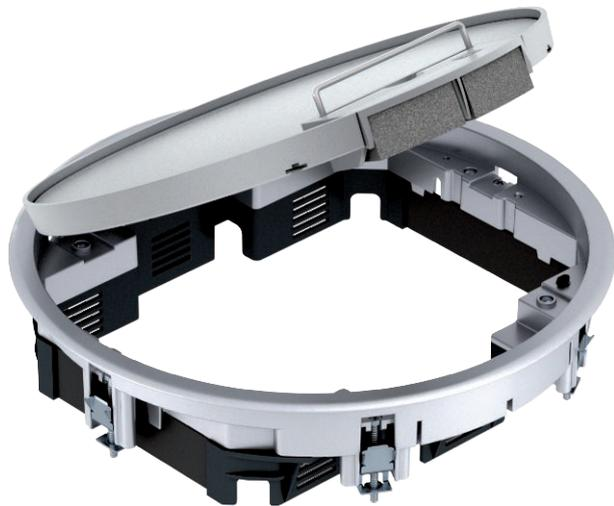
Geräteinsatz mit Griffbügel für bis zu 10 Modul 45-Einzelgeräte in 2 Universalträger UT3 und einem UT4, Einsatz in Kanalsystemen und Systemböden im Innenbereich.
