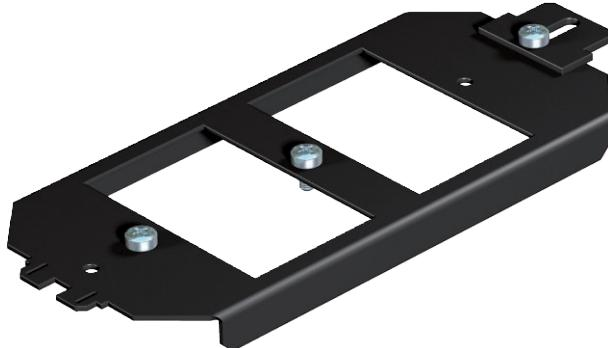
Montageträger zur Aufnahme von 2 Trägerplatten und einer Zugentlastung. Verwendung anstelle eines Gerätetechers UT3.
