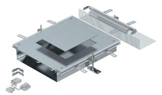
Montagefertige Kanalanbaueinheit mit einem Geräteeinbaudeckel zum Einbau einer Einbaueinheit der Nenngröße 9, bestehend aus Kanalunterteil (Bodenwanne mit Seiten- und Bodenbelagsanlegeprofilen), Kanaldeckel mit blind verschlossener Montageöffnung und einem Kanalendstück. Im Lieferumfang enthalten sind 3 höhennivellierbare Befestigungswinkel, 3 Estrichanker, 1 Deckelstoßunterstützung und 1 Bausatz für Winkelabzweig.
