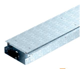
Montagefertige Kanaleinheit zur Leitungsführung, bestehend aus einem Kanalunterteil mit zwei Deckeln und zwei verstellbaren Bodenbelaganlegeprofilen zur Estrichabgrenzung in Bereichen von Türlaibungen und vor Heizkörpernischen. Im Lieferumfang enthalten sind zwei Deckelstoßdichtungen und ein Verbinder.
