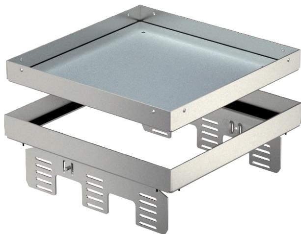
Nivellierbare und vom Fußboden entkoppelte Kassette "blind" für die Herstellung einer Revisionsöffnung der Nenngröße 9 in trocken oder nass gepflegten Fußböden im Innenbereich, zur Montage in Unterflurdosen UZD250-3 oder UZD350-3, jeweils in Verbindung mit einem Montagedeckel DUG../9 oder in UGD250-3/9 oder UGD350-3/9. Die Montage erfolgt mittels Nivellierwinkel (separat bestellen) im Aluminium-Rahmenprofil der Unterflurdosen. Nur für glatte Bodenbeläge geeignet.
