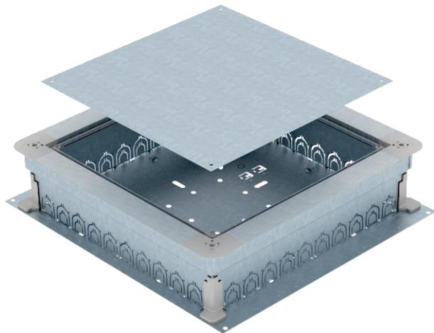
Unterflur Zug- und Abzweigdose für je 10 Installationsrohre pro Seite (M20 oder M32) mit Seitenwänden aus Stahlblech. Zur Montage von Einbaueinheiten in Montagedeckel (separat zu bestellen). Lässt sich stufenlos auf Estrichhöhe nivellieren (Schnellnivellierung möglich) und der Estrich kann bündig an die Estrichabzugskante angearbeitet werden. Mit schalltechnischer Entkopplungsmöglichkeit nach Estrichverlegung und mit Systemzubehör auch für Schwerlastanwendung verwendbar.
