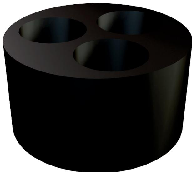
Einsatz zum Einführen mehrerer dünner Leitungen in die V-TEC-Kabelverschraubungen, wird gegen den einfachen Dichtring der Kabelverschraubung ausgetauscht.
