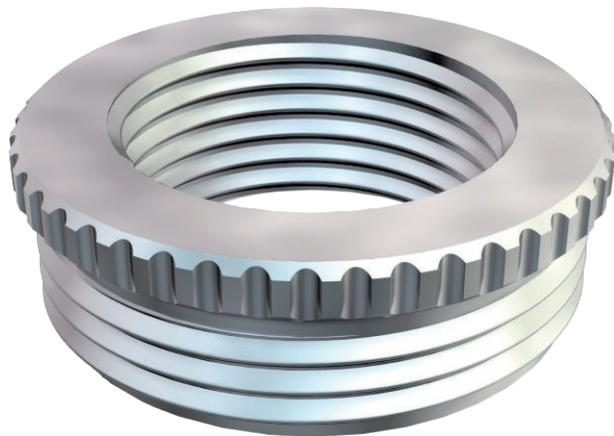
Reduktion (Teil H) nach DIN 46320, mit PG-Gewinde nach DIN 40430, zum Übergang von einem PG-Gewindeloch auf eine kleinere Kabelverschraubung.
