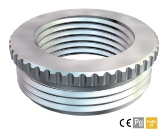
Reduktion (Teil H) nach DIN 46320, mit PG-Gewinde nach DIN 40430, zum Übergang von einem PG-Gewindeloch auf eine kleinere Kabelverschraubung.
