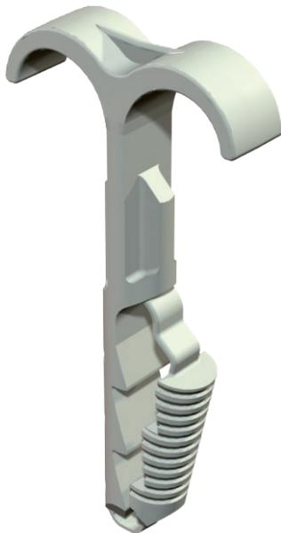
Die Steckschellen dienen zur Verlegung von Leitungen und Rohren an Wand und Decke und der Verlegung von flexiblen Rohren auf Beton und im Estrich. Die Doppelsteckschellen ersetzen Nagelclips in Beton und Gasbeton. Der Vorteil der Steckschellen liegt darin, dass sie nur in das Bohrloch gesteckt werden müssen. Es entfällt die Verwendung von Dübeln und Schrauben.
