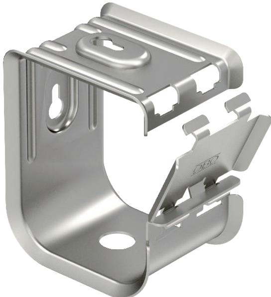
Sammelhalter aus Metall für hohe mechanische Standfestigkeit, auch im Brandfall. Zur sicheren Montage oberhalb von Brandschutzdecken geeignet. Auch als kabelspezifische Variante für den elektrischen Funktionserhalt nach DIN 4102 Teil 12 zugelassen. Für Wand- und Deckenmontage. Verschluss ohne Werkzeuge zu öffnen. Detaillierte Informationen der zugelassenen Verlegevarianten sind den entsprechenden Prüfdokumenten zu entnehmen.
