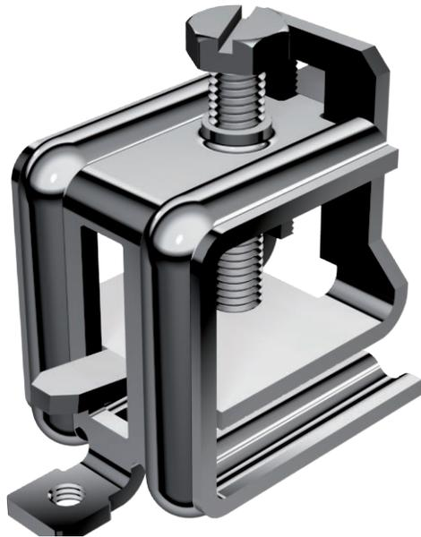
Zur schnellen Befestigung an Stahlprofilen bei der Montage von Kabelbahnen, Bügelschellen, Leuchtaufhängungen usw. Ein komplettes System besteht aus 2 Trägerschraubklammern und einem Stück C-Profilsschiene beliebiger Länge, sowie 2 Schutzkappen.
