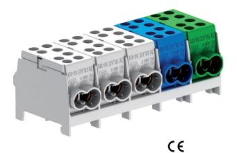
5-polige Hauptleitungsabzweigklemme mit 2 x 35 mm² + 2 x 25 mm² Leiteranschlussquerschnitten pro Pol. Mit 2 Schrauben pro Klemmstelle für einen sicheren Kontaktdruck. Hochfeste Schnellbefestigung aus verzinktem Stahlblech zur einfachen Montage auf Tragschienen.
