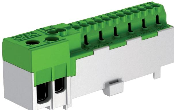
Neutralleiter-Anschlussklemme mit 12 Steckklemmstellen 2,5mm<sup>2</sup> bzw. 1,5 mm<sup>2</sup> flexibel mit Aderendhülse; zwei Steckklemmstellen 4 mm<sup>2</sup> bzw. 2,5 mm<sup>2</sup> flexibel mit Aderendhülse und zwei Schraubenanschlussklemmstellen bis 25 mm<sup>2</sup> bzw. 16 mm<sup>2</sup> flexibel, 3 Nm.
