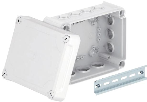
Kabelabzweigkasten zum Verbinden von Kabeln und Leitungen im Innenbereich und geschützten Außenbereichen. Rechteckige Form mit Einsteckdichtungen an den Seiten und Ausschlageinführungen im Boden. Geeignet für die Wand-/ Deckenmontage und die Montage auf Montageblechen. Mit der Möglichkeit zur Innenbefestigung und Montage über die Eckdome. Hoher Deckel mit Schnellverschluss, plombierbar. Hergestellt aus halogenfreien Materialien. Inklusive Hutprofilschiene.
