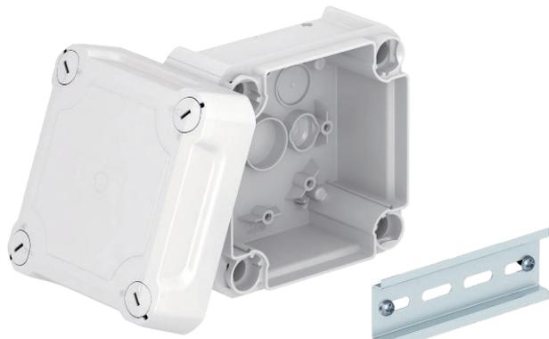
Kabelabzweigkasten geschlossen zum Verbinden von Kabeln und Leitungen im Innenbereich und geschützten Außenbereichen. Quadratische Form ohne Einführungen. Geeignet für die Wand-/Deckenmontage und die Montage auf Montageblechen. Mit der Möglichkeit zur Innenbefestigung und Montage über die Eckdome. Hoher Deckel mit Schnellverschluss, plombierbar. Hergestellt aus halogenfreien Materialien.
