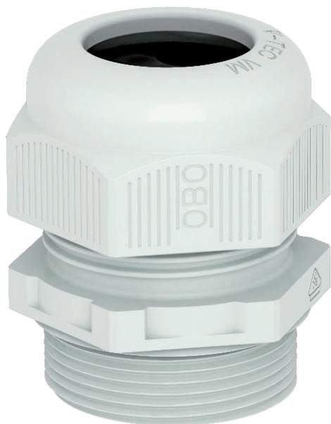
Kabelverschraubung mit metrischem Anschlussgewinde in Hutmutterbauart, für Kabelabzweiggkisten, Gehäuse, Verteilerschränke im privaten und industriellen Bereich. Mit Zugentlastung und integrierter Dichtlippe, geprüft nach DIN EN 62444. Schutzklasse IP68. Einsetzbar von -20°C bis +65°C.
